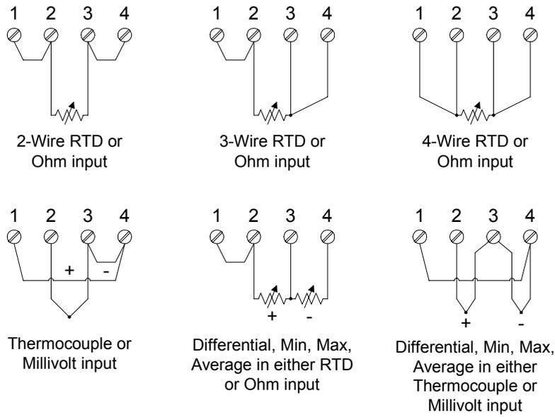
Fig. 1.5 – Sensor Wiring
