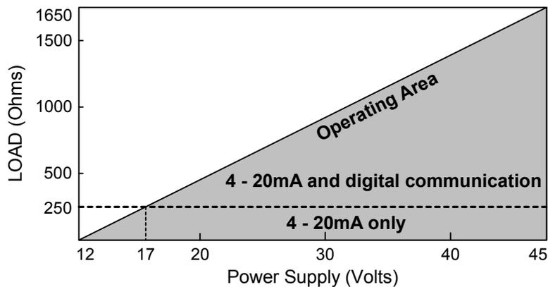
**Fig. 1.4 – Load Curve**
